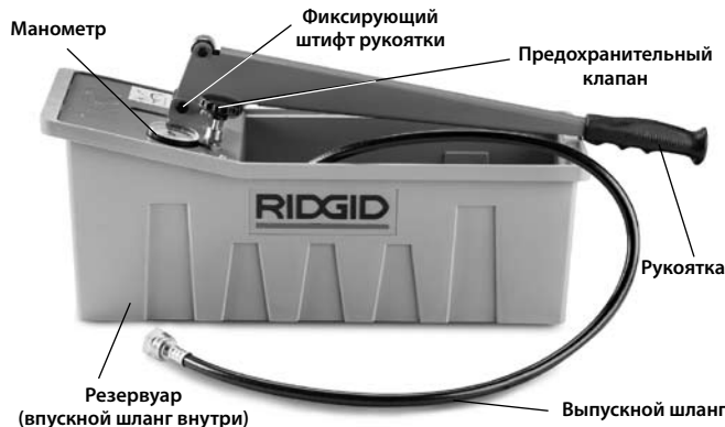
Рис. 1 – Испытательный гидропресс 1450
