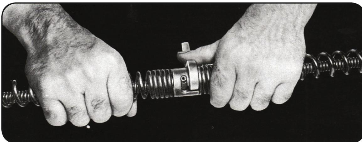
Разъединение спиралей с помощью специального ключа SC-18 (Рис. 2)
