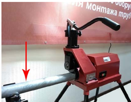
Рис. 6 Нажмите на трубу, когда силовой привод работает в режиме FOR
