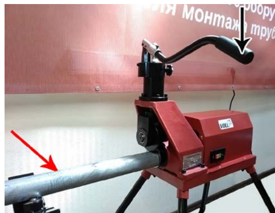
Рис. 7 Нажмите на трубу, когда силовой привод работает в режиме REV
