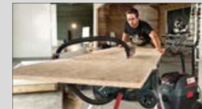
**Большие заготовки - не проблема** Значительная высота реза - 87 мм - и ширина реза - 630 мм - на параллельном упоре (TS 254)
