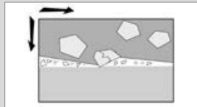
Металлическая связка удерживает каждый алмаз на своем месте. В процессе резки алмазы, выступающие на поверхность, вгрызаются в обрабатываемый материал и перемалывают его в тонкую пыль.
