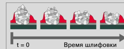
В керамическом зерне кристаллы оксида алюминия (Al<sub>2</sub>O<sub>3</sub>) связаны в процессе спекания. Под действием сил шлифовки эти микрокристаллы в процессе шлифовки обламываются и выпадают, поэтому абразивное зерно постоянно образует новые острые кромки.
