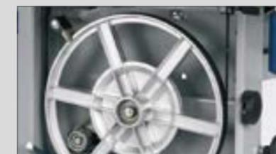
**Путем перестановки клинового ремня** в нижнем роликовом отделении можно выполнять предварительную настройку на одну из двух скоростей для идеального приспособления к распиливаемому материалу.
